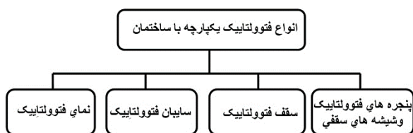
شکل ۱ انواع فتوولتائیک‌های یکپارچه با ساختمان [۲۰]
