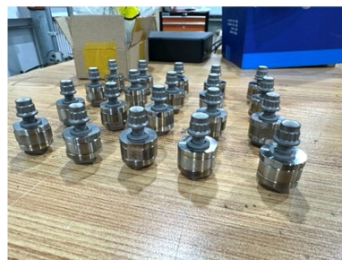
图 10 螺栓拧紧试验件实物图
